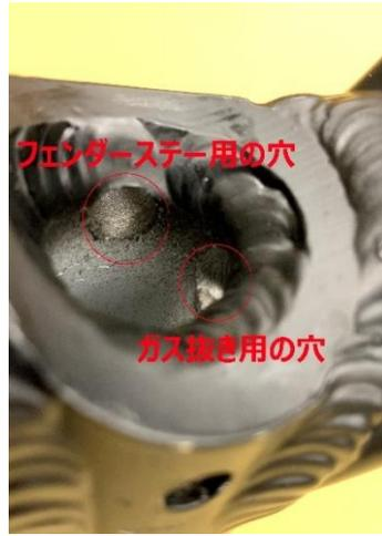
左図の様にフェンダーステー用の穴、ガス抜き用の穴が2箇所ずつの、計4つの穴があるか、確認。フェンダーステー用の穴は、外側から貫通しているのが、ガス抜き用の穴は、コラム下側からしか確認できない。**上記の4箇所以外に穴がある場合、報告書に必ず記載してください。**
